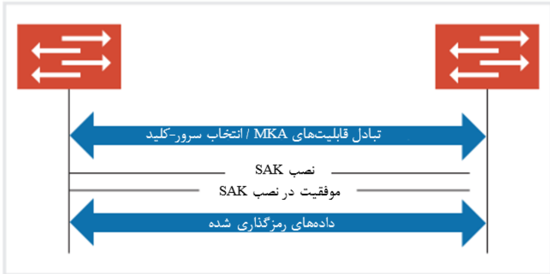
شکل ۱-۱۴- به منظور رمزگذاری payload و تولید ICV، دنباله MACsec به دو دستگاه قابل اعتماد - مانند سوئیچهای اترنت - بستگی دارد که یک کلید مشترک را از طریق MKA مبادله میکنند. پس از انجام این کار، آن‌ها میتوانند SAK را در مرحله زیر مبادله کنند.
