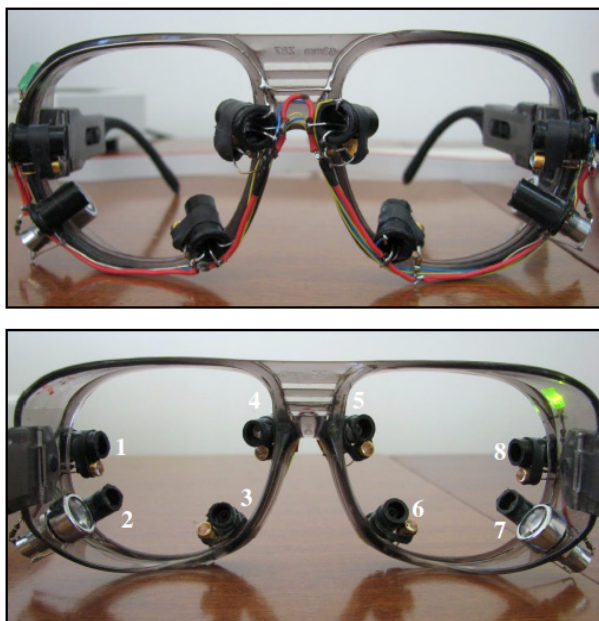
شکل (۱ - الف): عینک مخصوص با هشت سنسور و هشت منبع نورانی IrDA (سمت چپ) و (ب): یک دستگاه ردیابی حالات چشم متصل به سر (سمت راست)
