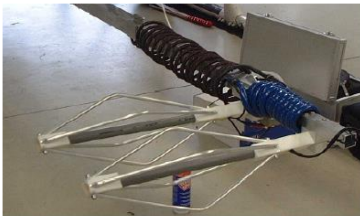
شکل ۱۲- نمونه‌ای از آرایه VHF مستقل از پلاریزاسیون
